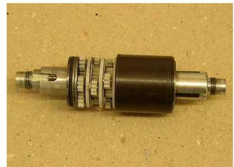
Innerer Teil eines Nabendynamos mit Getriebe (links, kleine graue Zahnrädchen) und zylinderförmigem Magneten (schwarz)
